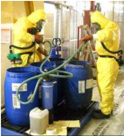
Opération de filtration des effluents
