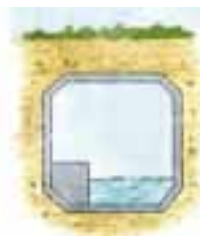
«Banquette» pour passage à Loutre.
