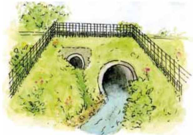
«Buse» pour passage à Loutre.
